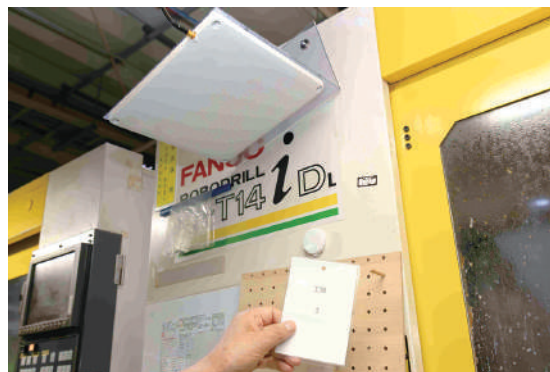
アンテナの角度やタグ位置を微調整し正確な稼働データを取得
