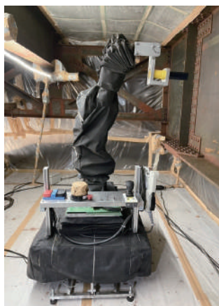
自動走行ロボット 橋梁用 (左)、道路用
