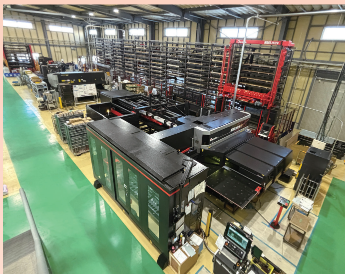
工場スペースに合わせた12段・10列の自動倉庫（奥壁面）と、この自動倉庫との連動で24時間無人加工にも対応可能なファイバーレーザーパンチ複合機（手前）
