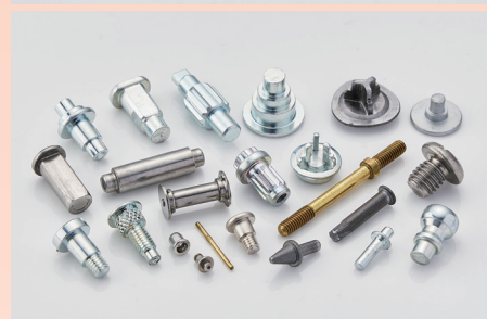
(上)加須工場内 (下)冷間圧造(フォーマー) 特殊形状品(ねじ、リベット、中空リベット・シャフト・ピン、パイプ・カラー、ロールホーミング転造による(ローレット、セレーション、ギヤ、溝、もみ切り、バニシング・らせん形状等)) 加工線形:1mm~20mm 加工ねじ径:1.6mm~20mm
