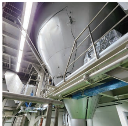
スプレードライヤー 製造能力 100kg～600kg乾燥粉末/日
