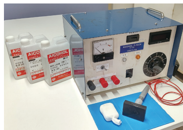
アイコールプレーティング（高速部分めっき法）：専用整流器、電極、めっき液を使用し、高速部分めっきが可能
