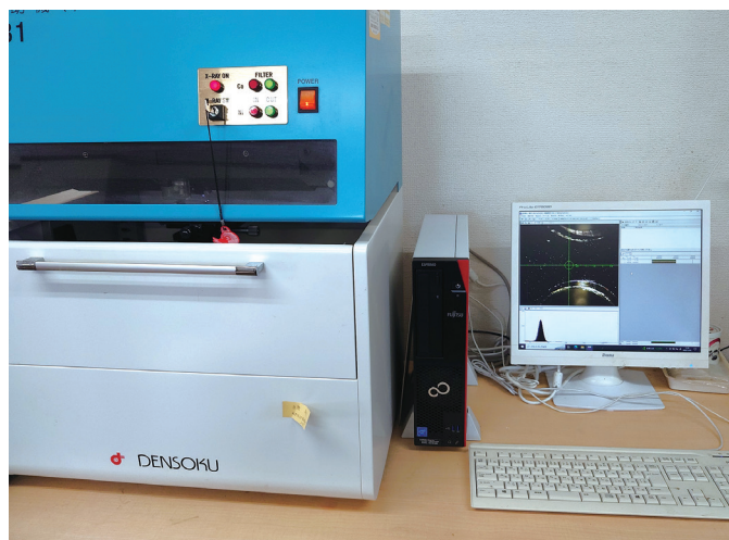
蛍光X線式膜厚測定器：めっき皮膜から放射される蛍光X線の量を測定してめっき厚を計測
