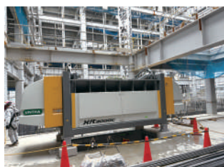
荏原環境プラント社製旋回流型流動床焼却炉(TIF)(左)、UNTHA社製破砕機
