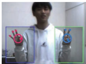
離れた位置から手指の細かい動きを用いた操作ができる空中マルチタッチインターフェース
