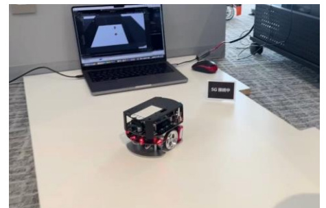
ロボットの実機と仮想のデジタルツイン
