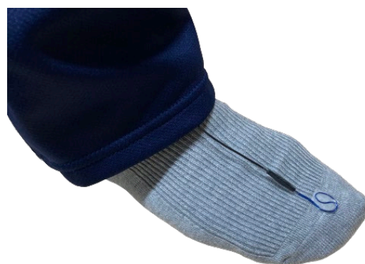
足趾上部に発生する剪断力計測
