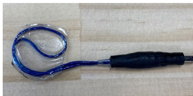
極細径ピエゾワイヤセンサ計測部
