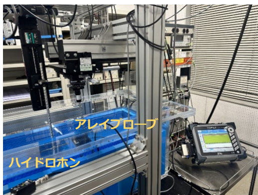
超音波探傷イメージング用アレイプローブから照射される超音波音場の測定
