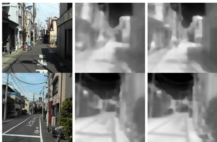
左列：カラー画像（入力）、中央列：pix2pixによる熱画像（出力）、右列：サーモカメラによる熱画像（正解画像）
