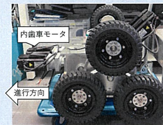
図7：製作した車輪部
