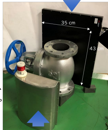
バッテリー駆動X線源(200 kV)
