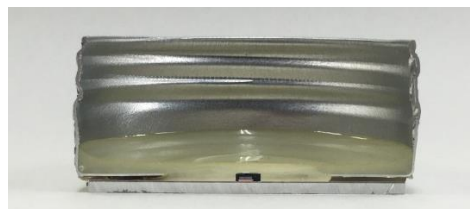
図3 接着剤を入れた測定セルの断面図
