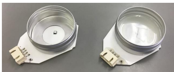
図1 水分拡散係数測定セル(左)とセルに接着剤を注いだ様子(右)
