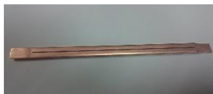
厚さ2mmの銅板に0.3mmX75mmのスリット孔をワイヤー加工からプレス加工に
