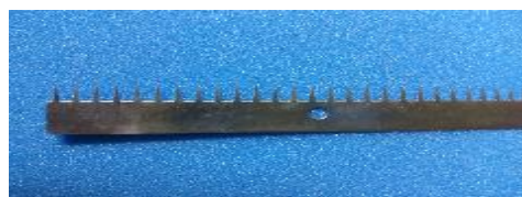
厚さ0.1mmのステンレス板 エッチングから順送りプレス加工に
