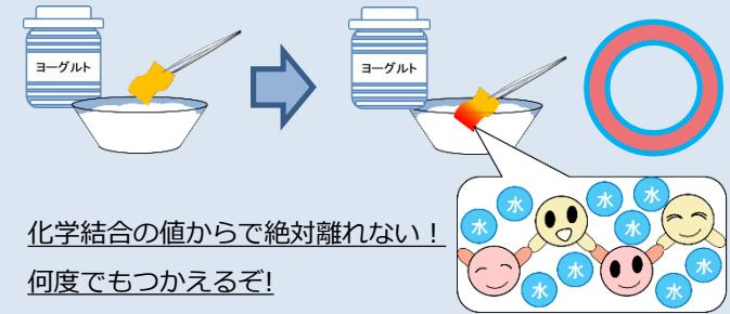
○pH試験紙やpH電極の場合、水中へ内部の薬液が溶け出てしまう。開発した色調変化型高分子フィルムは、色調変化を示す部位が化学結合しているため水中に溶出せず、水溶液を汚染しない。
