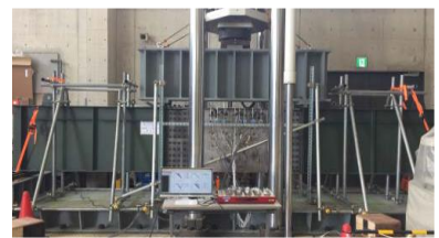
3000KN試験機での耐荷力実験
