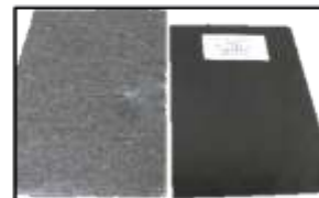
長尺CNT/PPとリサイクルCF 不織布の積層強度部材
