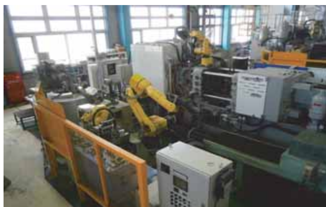
セミソリッドダイカストの完全自動化ライン
