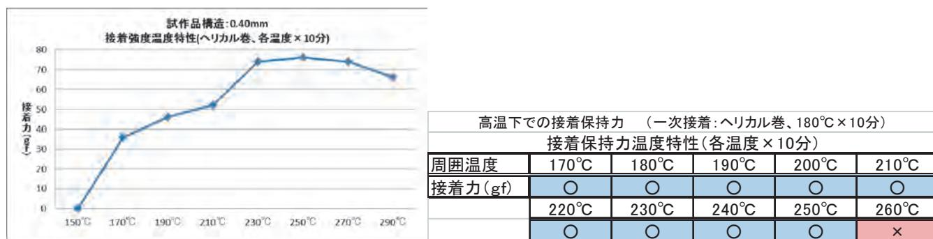
多重塗装エナメル線として用いる場合、接着用樹脂組成物として適切な素材が少なく、組み合わせる樹脂組成物によっては、ポリイミドエナメル線が持っている高い耐熱性を損なう難点があった。これまでにもポリイミド系樹脂組成物を接着層に用いたセルフボンディングエナメル線は報告されているが、接着に 240°C以上の高温度で加熱する必要があり、広く利用されるまでには至っていない。今回開発した製品は、こうした課題をクリアしており今後、多岐にわたるニーズが期待できる。
