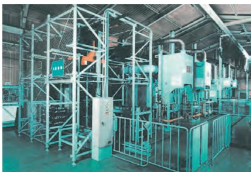
当社熱処理設備全自動監視システムは、洗浄や各熱処理炉の処理条件の設定変更まで、全てのプロセスをCRT画面とキーボード操作による対話形式で行えるハイテクノロジーシステムです。処理品をセットし、処理パターンを設定しさえすれば、後は一切が全自動。無停電装置の標準装備による無人化対応の実現や、作業環境の改善、さらに高品質化が図れるなど、その実力を如何なく発揮しています。
