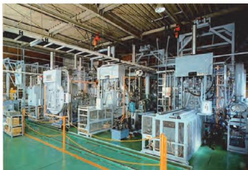
高速度鋼、ダイス鋼、ステンレス鋼の焼入、焼戻し、時効処理、ロー付等・・・ガス冷却噴射ノズルは、上下に配置されているので、ガスが均一に流れ焼入れ歪が少ない。最大3Barの高圧ガスを高速に循環させるため、急速冷却ができ高速度鋼及び大物ダイカスト金型、プレス金型の熱処理に最適です。
