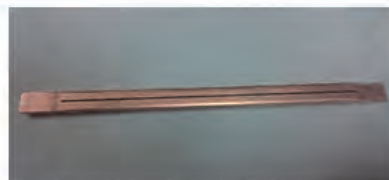
厚さ2mmの銅板に0.3mm×75mmのスリット孔をワイヤー加工からプレス加工に
