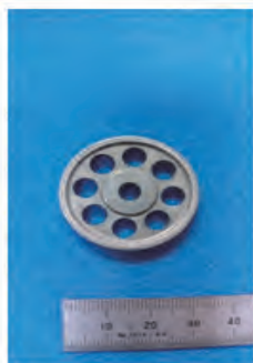
鉄製機械加工からアルミ製プレス加工 プラス熱処理で軽量化とコストダウン
