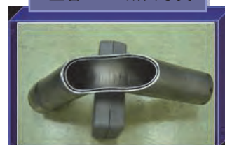
2重管 PIPE 断面写真
