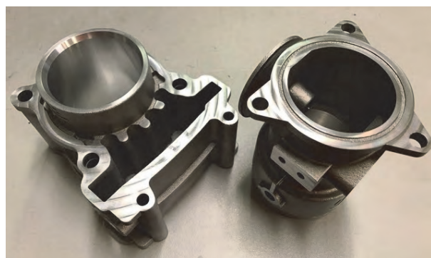
左：アルミ製バルブ 右：マルエージング鋼
