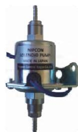
定容積形電磁ポンプは、プランジャ・ピストンの往復する距離（ストローク長）を構造により規制することによって、一定の容積変化が繰り返され、背圧変動などの外乱影響を受け難い特徴をもっています。
