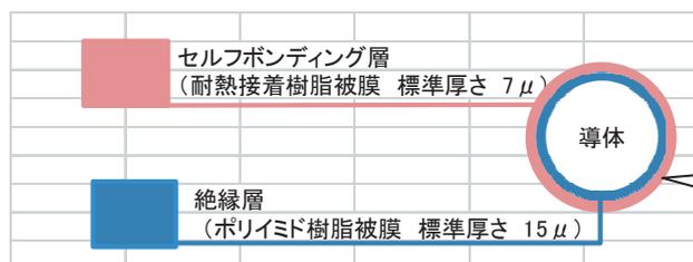
「セルフボンディング・ポリイミドエナメル線 SB-PIW」の構造は、銅・合金線などの導体を絶縁層とセルフボンディング層で被覆した形となっている。
