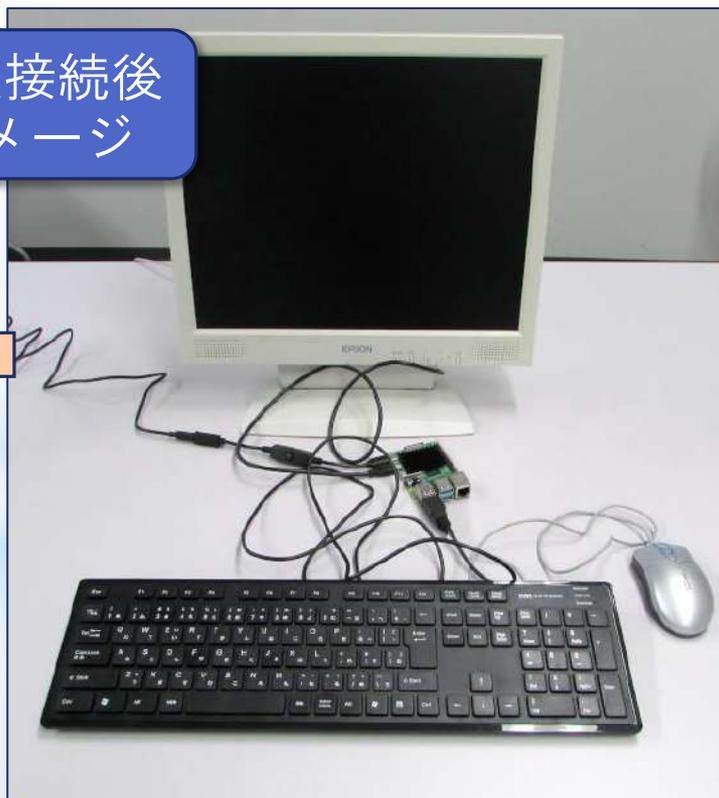
ONにすると、基板上のLEDが点灯・点滅します。
