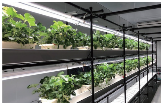
かんすい 環境・灌水・LED光・風等を自動制御するスマートシステムの開発により、日本初の閉鎖型イチゴ栽培工場を実現
