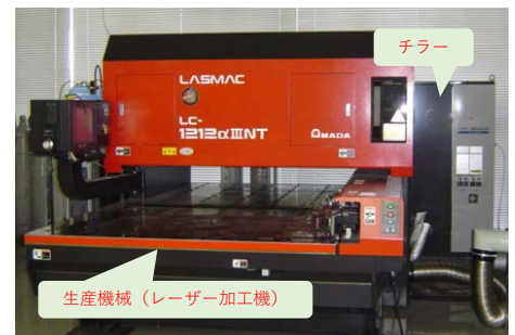
図1 ものつくり大学における例(生産機械とチラー)
