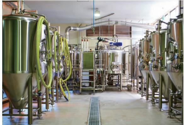
1850Lの大型タンク3基と、822Lの小型タンク8基を設備し、年間100種以上のクラフトビールを醸造する
