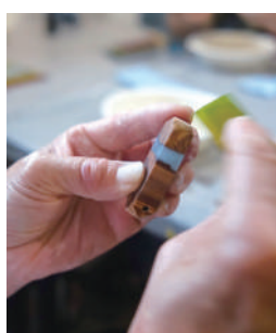
オリーブの木とレジンで段差なく丁寧に磨く研磨作業
